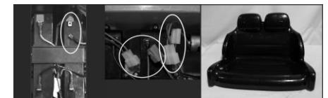
6. Langkah pertama hubungkan kabel merah (+) pada terminal merah. Langkah kedua, sambungkan soket kabel gear box ke kabel utama. Langkah terakhir, memasang jok dengan cara megaikkan kuncian pada bagian belakang jok ke body kemudian kencangkan dengan sekrup.
