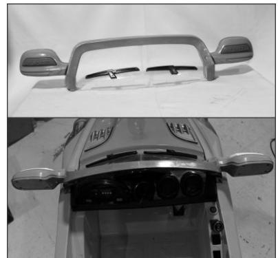
4. Pasang frame kaca debu ke body, tekan hingga mengunci lalu kencangkan dengan sekrup pada bagian kiri dan kanan.
