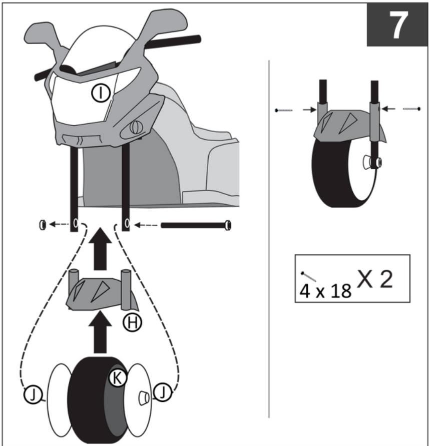
7) Pasang **H** dengan **I**, pasang 2 buah **J** di **K** lalu pasang **K** di **I** menggunakan baut dan alat yang telah disediakan. kencangkan dengan sempurna.
