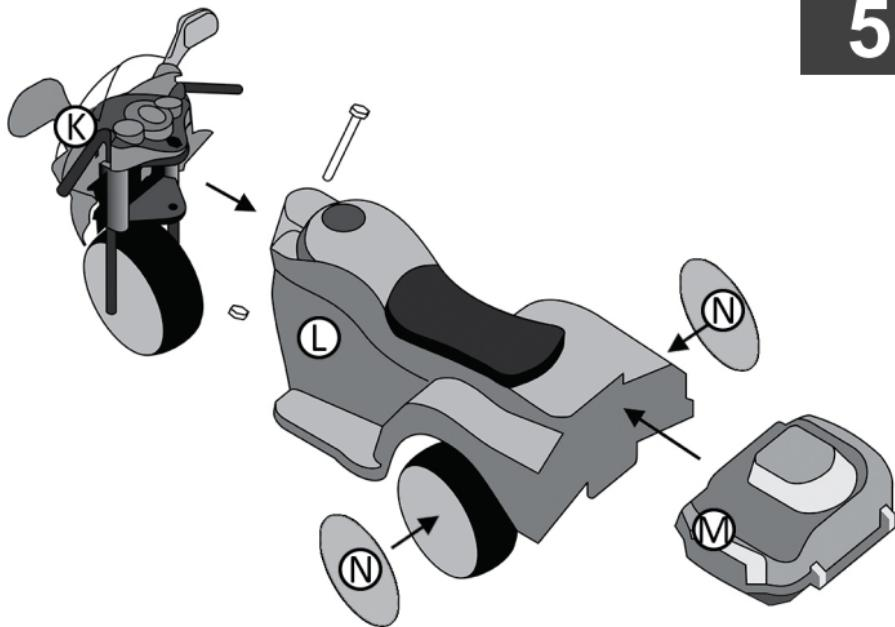
5) Rangkai **K**, **L**, **M** dan **N** menjadi satu, amankan dengan baut dan mur yang telah di sediakan. Kencangkan baut dengan alat bantu yang sesuai, dilarang mengencangkan baut hanya menggunakan tangan kosong. Pastikan **M** terpasang dengan baik.
